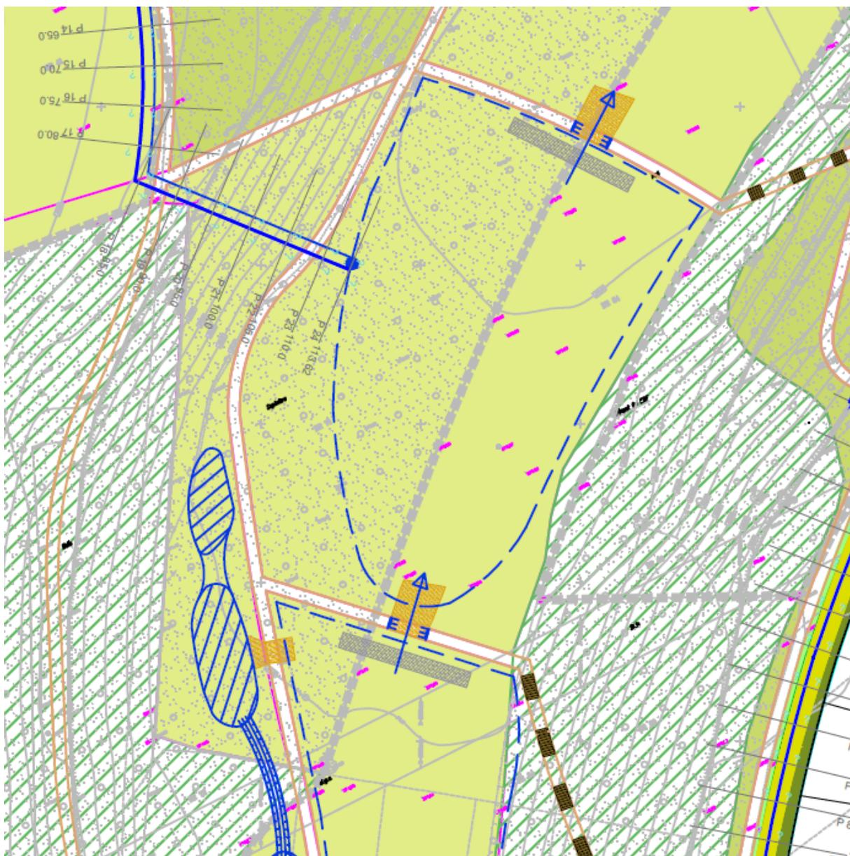
Ces zones de ralentissement dynamique des crues du bassin versant amont seront contrôlées par des systèmes de digues transversales assurant la rétention d'eau sur plus de 6 600 m<sup>2</sup>. La régulation se fera par ajustage à 625 L/s. Une surverse de sécurité sera aménagée entre chaque zone pour garantir le contrôle des trop-pleins.
